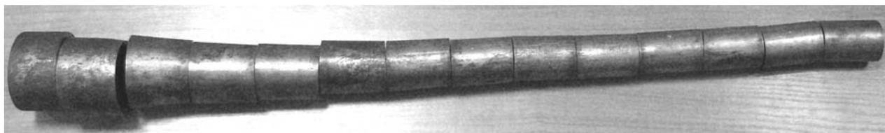
Рис. 3. Исследуемая заготовка трубы, прокатанная на стане ХПТ-55 по маршруту  $57 \times 7,5 \rightarrow 31 \times 3,5$
